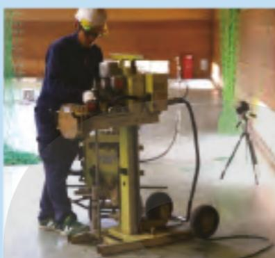
GSISではより精度の高い地盤の改良強化を行うため、地盤の調査にはスウェーデン式サンディングを採用し綿密な調査を行います。スウェーデン式サンディングは戸建住宅向けの地盤調査に採用されている信用性の高い調査です。
